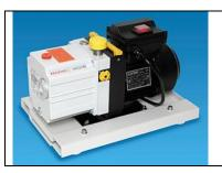
Système de pompage avec pompe à palettes double étage 3.0m3/h, montée sur table anti-vibration (33x22 cm) se positionnant sur le plan de travail, derrière l'appareil. Raccordement par soufflet métallique. Grande vitesse de pompage: 0,1 mbar obtenu après 30 secondes.
