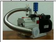
\* Pompe à palettes double étage 3 m3/h, montée sur support, se positionnant sur le plan de travail, derrière l'appareil. Kit de raccordement par soufflet métallique, y compris Filtre de sortie. Grande vitesse de pompage : 0,1 mbar obtenu après 30 secondes.
